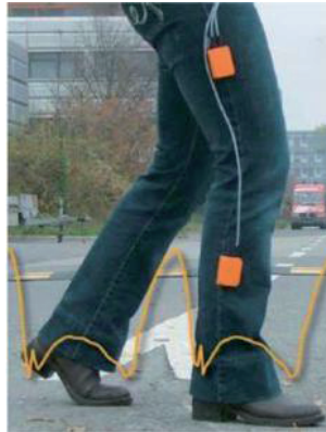
FIGURA 14: Concepto de PDR: una o varias IMU están unidas al cuerpo de una persona para estimar su posición, velocidad y orientación
